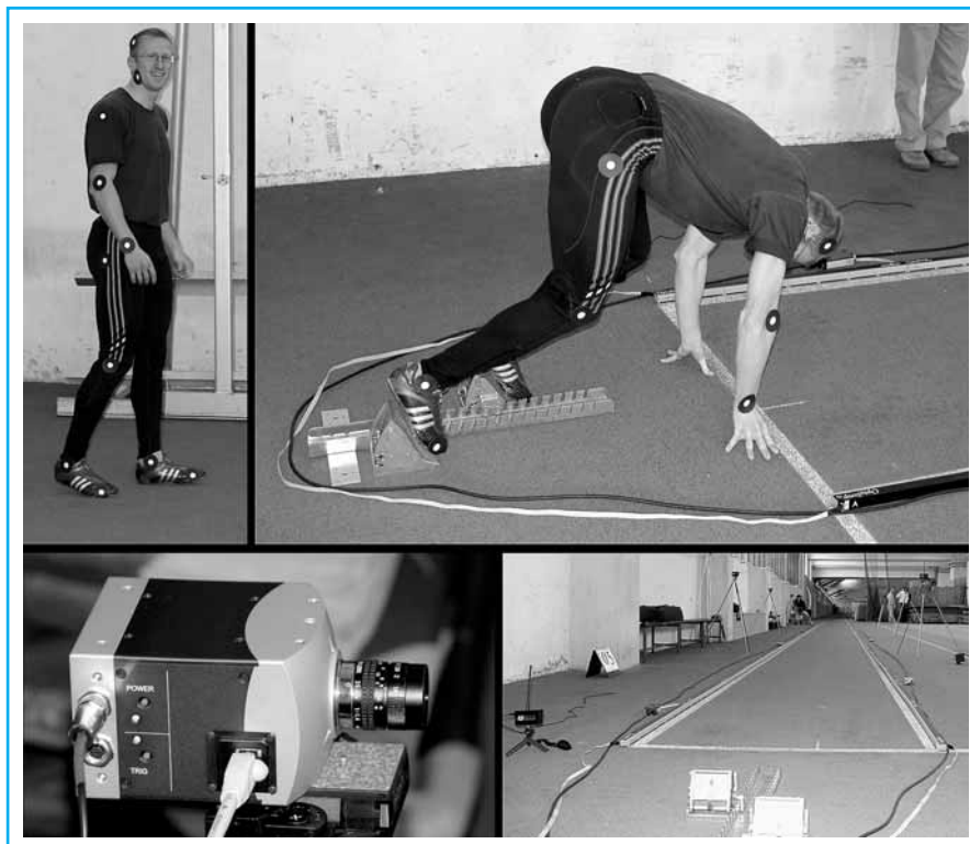
Figura 1 - Sistema di misurazione dei parametri cinematici della partenza di velocità e dell'accelerazione dai blocchi.
