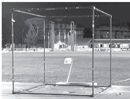
Figura 2 - Posizione del cubo di calibrazione rispetto alla pedana di lancio, camera T3.
